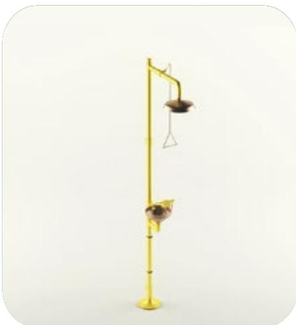
R alis e avec des tuyaux en acier galvanis , des raccords en laiton et un rev tement anticorrosion de couleur jaune ou rouge   haute visibilit . Pression d'entr e d'eau recommand e 2 bar/Min. 1,5 bar/Max. 8 bar.
